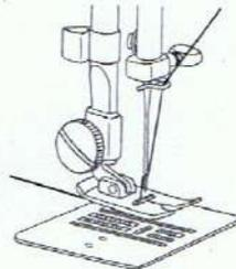
Nun den Faden von der Garnrolle aus zur oberen Fadenführung (1) bringen und um diese herum über den Führungsstift.
