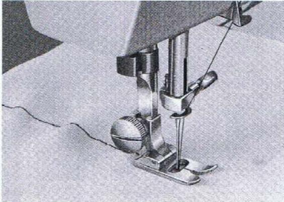
Wenn Sie die Maschine lt. Tabelle eingestellt haben, drehen Sie die Oberfadenspannung lockerer, etwa auf 1.
