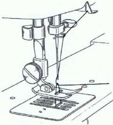
2. Nun zieht der Oberfaden den Unterfaden in einer Schlinge herauf.
