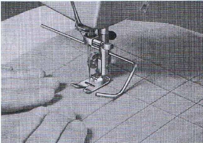
Lösen Sie die Nähfußhalteschraube und befestigen Sie die Halterung des Wattierlineals zwischen Nähfuß und Halteschraube.
