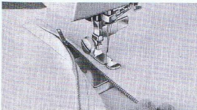
Montieren Sie den Reißverschußfuß und stellen Sie die Maschine ein, wie oben angegeben. Lockern Sie die hinten am Fuß angebrachte Rändelschraube. Nun können Sie die bewegliche Sohle des Fußes so weit verschieben, daß die Nadel in die Aussparung der Sohle eintritt.
