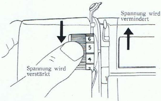
Wie auf Seite 24 dieser Anleitung gezeigt, kann die Oberfadenspannung leicht eingestellt werden. Je höher die Zahl, desto fester ist die Spannung! Bei zu niedriger Spannung den Knopf nach unten drehen.
