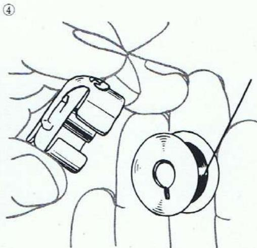
4. Die Spule fällt nicht aus der Kapsel, wenn sie an der geöffneten Spulenkapselklappe festgehalten wird. Läßt man die Klappe los, fällt die Spule heraus.
