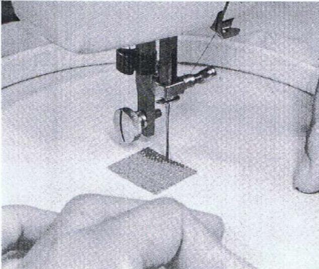
Stellen Sie die Maschine lt. obiger Tabelle ein. Beachten Sie: der Transporteur ist auf UNTEN. Unterlegen Sie die schadhafte Stelle, falls nötig. Legen Sie diese dann unter den Nähfuß und lassen ihn herab, da sonst die Fadenspannung nicht wirksam wird.
