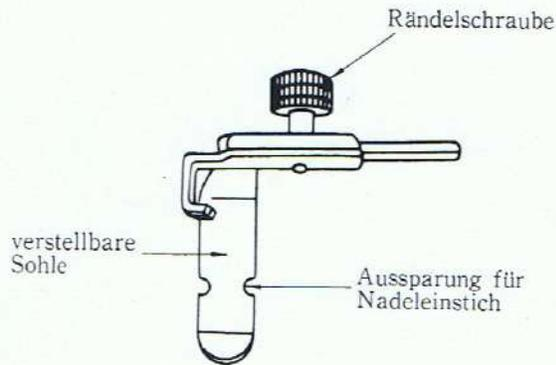
Reißverschlüsse sind modern und praktisch. Mit dem Reißverschußfuß können Sie rechts und links dicht an den Reißverschußgliedern entlang nähen, ohne diese oder die Nadel zu beschädigen, denn dieser Fuß hat eine verstellbare Sohle.
