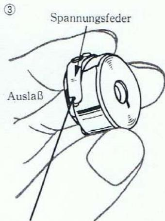
3. Den Faden nach links unter die Spannungsfeder ziehen, bis der Faden aus dem kleinen Auslaß herauskommt.
