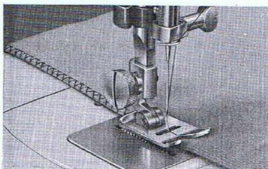
Der Overlockstich ist eine besonders dehnbare Naht, mit der Sie z.B. Wäschestücke aus Trikot nähen und gleichzeitig die Schnittkanten versäubern können. Auch zum Einsetzen von Flickern ist diese Naht gut geeignet, ebenso als Ziernaht.
