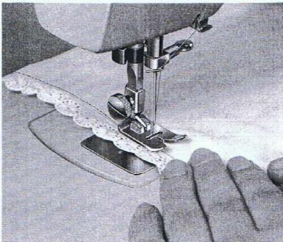
Die Spitze etwa 5 mm von der Stoffkante entfernt auf den Stoff und unter den Nähfuß legen.
