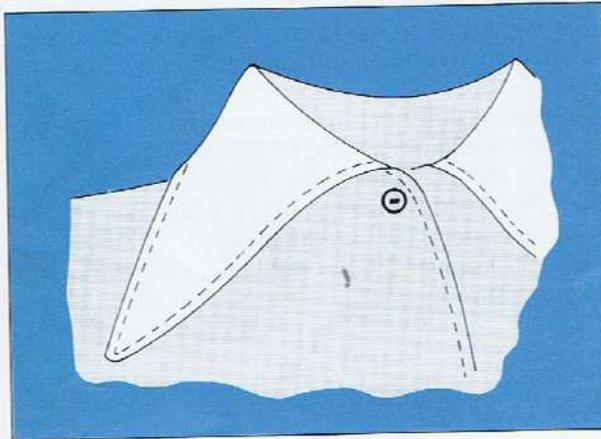
Bei dieser Naht sticht die Nadel immer in die linke Seite der Nähfußöffnung.
