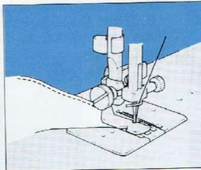
2. Während die Nadel im Stoff steckt, heben Sie den Nähfuß und ändern Sie die Nährichtung.
