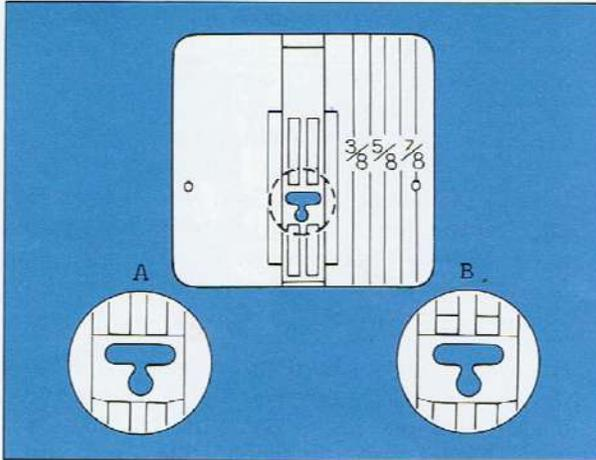
Wenn Sie durch Drehen des Stichbreitenknopfes den Geradstich (mittlere Stichlage) oder den Kettenstich wählen, verändert sich die Öffnung in der Stichplatte automatisch auf eng (A). Dadurch ersparen Sie sich das mühevollere Auswechseln der Stichplatte.
