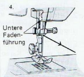
Vor dem Einfädeln den Nähfuß und den Gelenkfadenhebel in die höchste Stellung bringen.
