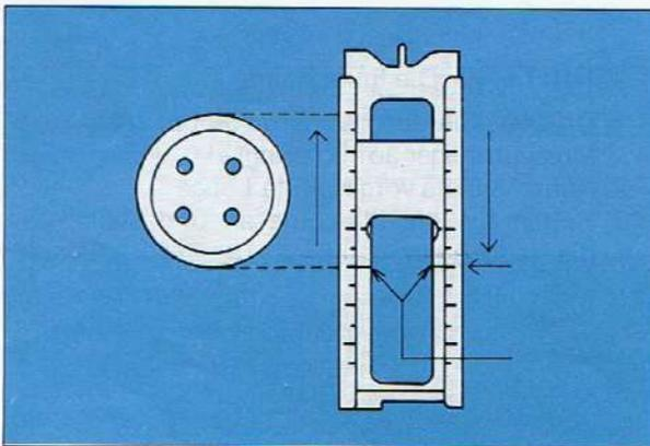
1. Stellen Sie die Linealschiene des Knopflochfußes auf die Größe des entsprechenden Knopfes ein und Nähen Sie Schritt A.
