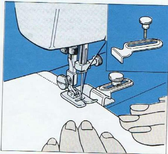
Das Kantenlineal hilft Ihnen gerade und parallele Nähte entlang der Stoffkante zu machen. Das Kantenlineal wird in den beiden Gewindelöchern rechts von der Stichplatte befestigt.
