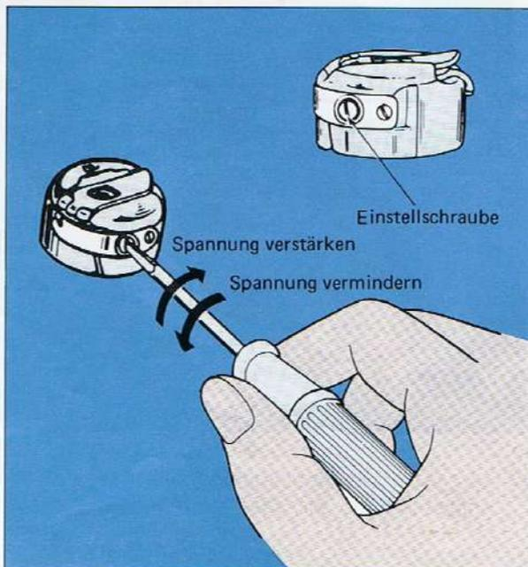
Die Unterfadenspannung wurde schon vor der Verschickung von der Fabrik für das Nähen allgemeiner Näharbeiten eingestellt. Bei besonders leichten oder sehr schweren Stoffen muß aber auch die Unterfadenspannung reguliert werden.
