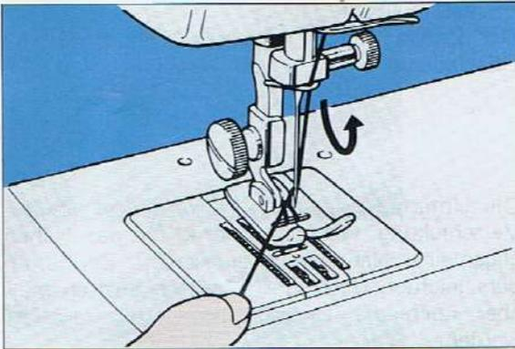
1. Halten Sie mit der linken Hand das Ende des Oberfadens fest. Drehen Sie mit der rechten Hand das Handrad zu sich, bis die Nadel hinunter und wieder in die höchste Stellung zurückgeht.
