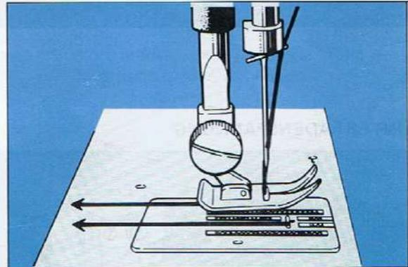
3. Ziehen Sie beide Fäden nach hinten unter den Nähfuß. Die Fäden sollen ca. 10 cm lang sein.
