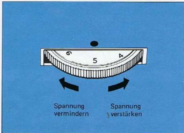
Regulieren Sie die Oberfadenspannung, indem Sie ganz einfach die Oberfadenspannung-Regulierscheibe mit dem Daumen drehen, nachdem Sie zuvor den Nähfuß gesenkt haben. JE HÖHER DIE ZAHL, DESTO FESTER DIE SPANNUNG.
