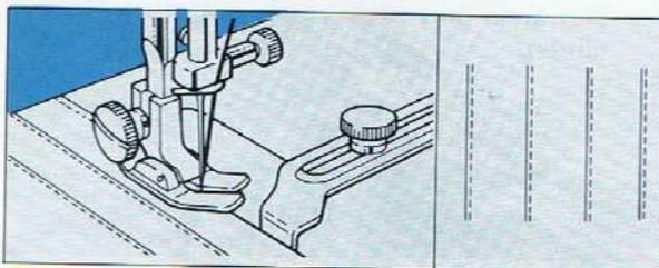
1. Befestigen Sie das Kantenlineal an der Maschine.
