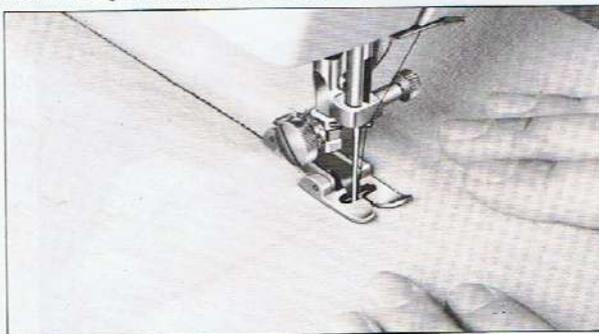
Dieser "Dreifach-Stretch-Stich" wird bei dehnbarem Material, wie z.B. Strickstoff, Trikot usw. verwendet. Die Naht ist dreimal so stark wie eine normale Naht und auch wesentlich dehnbarer.
