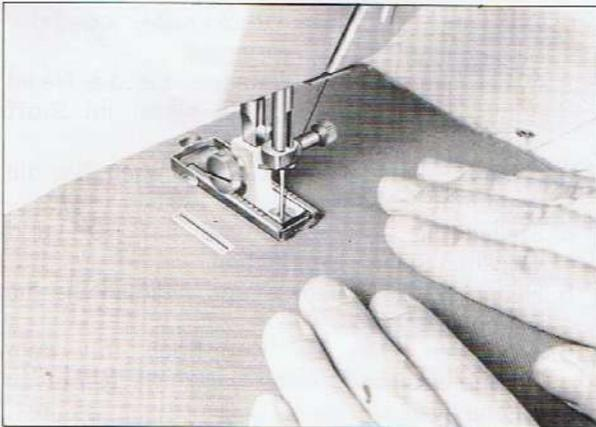
1. Verwenden Sie den Knopflochfuß mit der Linealschiene.
