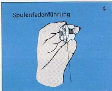
1. Wickeln Sie ca. 5 cm Faden von der Spule ab. Legen Sie die Spule in die Kapsel ein.
