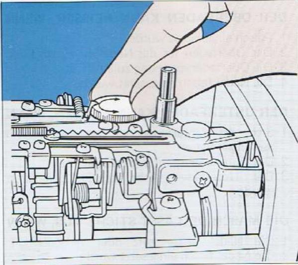
Wir haben Ihre Nähmaschine schon vor der Verschickung justiert, um eine richtige Einstellung der Zierstiche mit der Rückwärtsnaht, Nr. 1–10, zu gewährleisten. Wenn die Maschine jedoch lange verwendet wurde, können diese Muster ungenau werden. Daher gibt es unter dem Kopfdeckel einen Knopf für die genaue Justierung der Zierstiche mit der Rückwärtsnaht.
