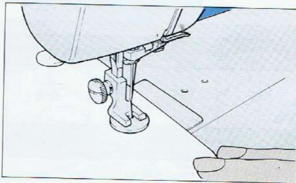
1. Legen Sie den Knopf zwischen Nähfuß und Stoff. Achten Sie darauf, daß sich die Löcher des Knopfes auf der Höhe der Grundlinie des Nähfußes befinden.
