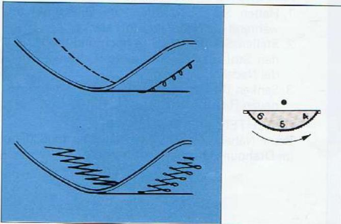
Der Unterfaden liegt auf der Unterseite des Stoffes und zieht den Oberfaden wie gezeigt nach unten.
