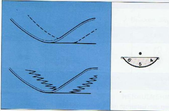
Die Spannung von Ober- und Unterfaden sollte gleich und gerade so fest sein, daß sich die Verschlingung beider Fäden in der Mitte des Stoffes befindet.
