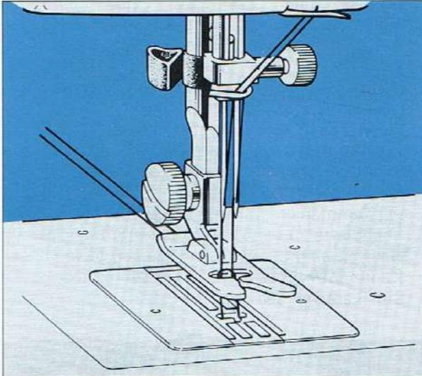
Ihre Nähmaschine ist speziell für das Nähen mit der Zwillingssnadel ausgerüstet.
