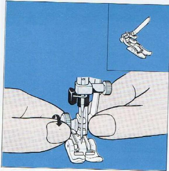
Dieser Stretchstichfuß ist ideal zum Nähen moderner Stretchstoffe und elastischem Material. Er verhindert, daß die Maschine Stiche ausläßt, wie dies auch die goldene Stretch-Stich-Nadel tut. Zum Einsetzen und Entfernen dieses Nähfußes folgen Sie den unten angegebenen Anleitungen.
