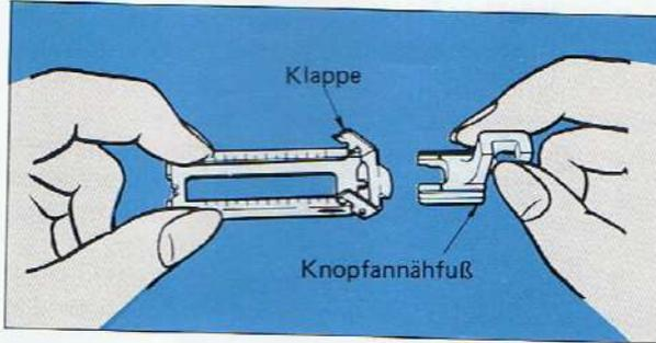
Wenn Sie die Linealschiene vom Knopflochfuß entfernen, erhalten Sie den Knopfannähfuß. Zum Entfernen der Linealschiene drücken Sie die Klappe hinunter und ziehen Sie den Knopfannähfuß nach hinten aus der Schiene.
