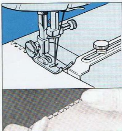
Dieser Stich kann bei dehnbarem Material zum Nähen einer Überwendlingnaht (Overlock-Naht) verwendet werden.
