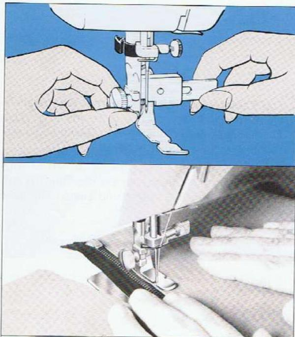
1. Senken Sie die Nadel in die Aussparung der Sohle und überprüfen Sie die Stellung des Nähfußes, um zu verhindern, daß die Nadel auf den Nähfuß trifft.
