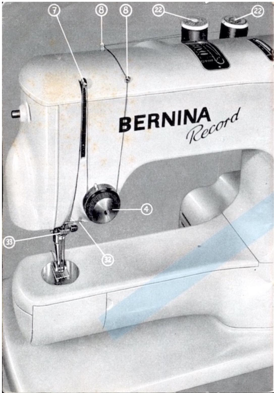
**Einfädeln der beiden Oberfäden** Fig. 52
