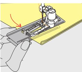
**Zum Nähen eines Knopflochs in schwierigen Stoffen empfiehlt es sich die Transporthilfe (in einigen Ländern nur als Sonderzubehör erhältlich) zu verwenden. Sie kann nur zusammen mit dem Knopflochschlittenfuss Nr. 3A verwendet werden.**
