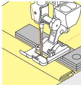
Zum Ausgleichen der Nahthöhe je nach Bedarf ein, zwei oder drei Plättchen des Höhengleiches hinter die Nadel unter den Nähfuss legen.
