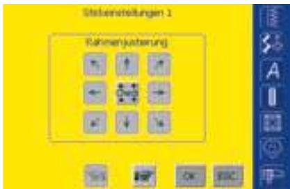
Die Rahmenjustierung ist die Abstimmung der Nadel zur Mitte des Rahmens. Die Justierung kann nur bei angeschlossenem Stickmodul und montiertem ovalen Stickrahmen ausgeführt werden. Sie muss nur einmal erfolgen, da sie für alle Stickrahmengrößen gleichermassen gilt.
