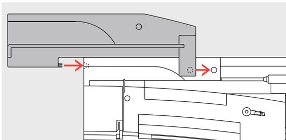
Der Adapter ermöglicht das Sticken von geschlossenen Gegenständen (Ärmel, Hosenbeine, Socken, Schlauchware usw.) um den Freiarm des Nähcomputers.
