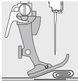
Wenn der Nähfuss an einer dicken Nahtstelle «schräg» steht, kann der Transporteur nicht in den Stoff greifen. Das Nähgut staut.
