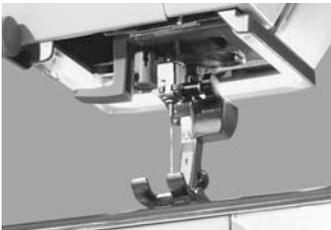
Das CFL-Nählicht zeichnet sich – im Gegensatz zu einer herkömmlichen Glühlampe – durch eine bessere Ausleuchtung des Nähbereiches sowie durch eine sehr hohe Lebensdauer aus.
