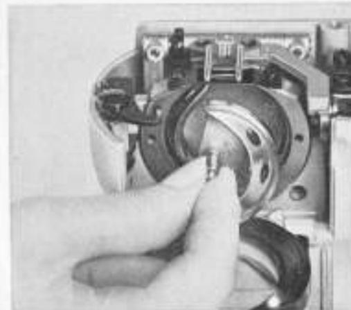
Après avoir retiré le crochet, nettoyer la coursière à l'aide du pinceau et d'un chiffon de coton. Ne pas utiliser d'objets durs, tels que tournevis, ciseaux, etc. pour enlever les débris de fil.
