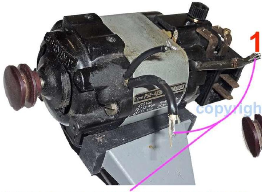
**Kabel 1** muss jetzt nur noch **mit dem längeren** der beiden anderen **Kabel verbunden werden.**
