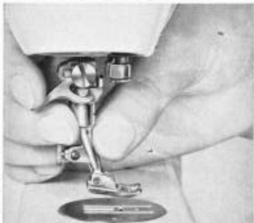
Benötigten Nähfuß anstecken und Befestigungshebel nach unten drücken. Der Nähfuß ist sicher befestigt und die Maschine bereit für die neue Näharbeit. Das bietet nur Bernina.
