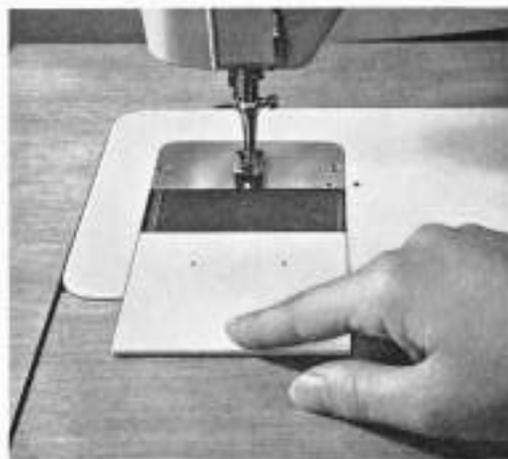
Spulenkapsel am Scharnierkläppchen fassen und herausnehmen (mit Daumen und Zeigefinger der linken Hand). Das Einsetzen der Spulenkapsel erfolgt in gleicher Weise.
