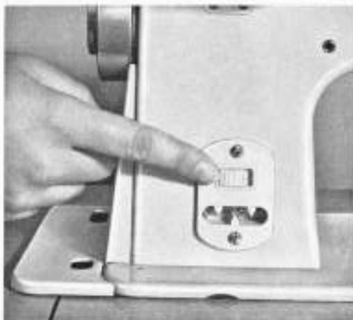
**Nählicht.** Durch Druck auf die Wippe (7) wird das blendfrei eingebaute Nählicht ein- oder ausgeschaltet. Zum Auswechseln der Glühbirne Kopfdeckel aus-schwenken. Die Glühbirne nach oben drücken, links drehen und nach unten ausfahren. Einsetzen gegengleich.
