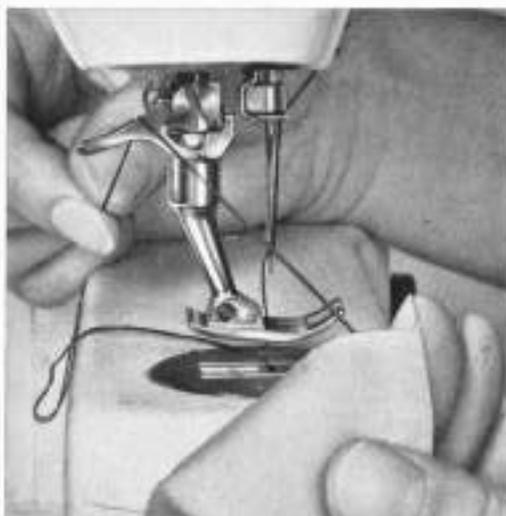
**Fadenabschneider.** Der Nähfußbefestigungshebel ist so ausgebildet, daß er auch als Fadenabschneider benutzt werden kann. Diese kleine Einrichtung hilft viel Zeit sparen, besonders dann, wenn eine Schere nicht griffbereit ist.
