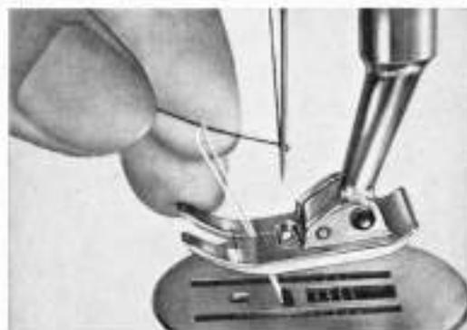
**Das Versenken des Transporteurs.** Für gewisse Näharbeiten, hauptsächlich beim Stopfen, muß der Transporteur versenkt werden.
