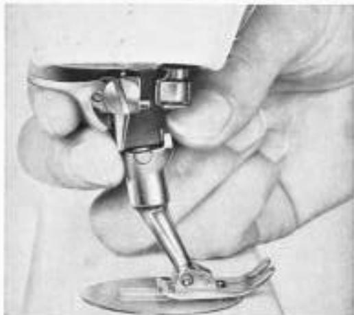
Befestigungshebel lösen und Nähfuß abnehmen.
