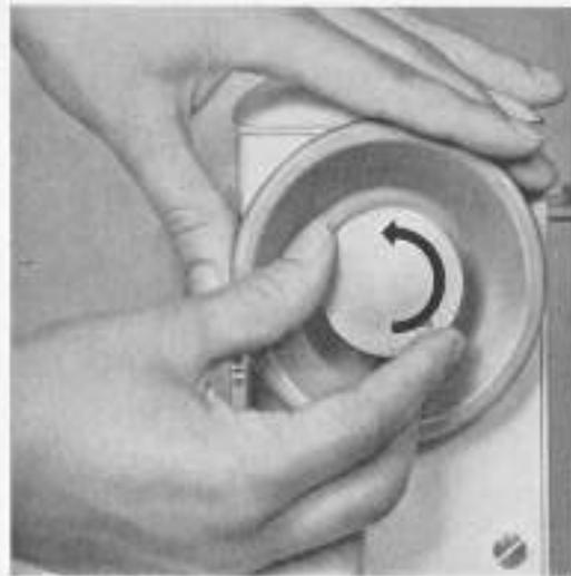
Spulerachse auf dem Ständerdeckel nach rechts drücken und Kapselspule aufsetzen. Spuler ist jetzt eingeschaltet.
