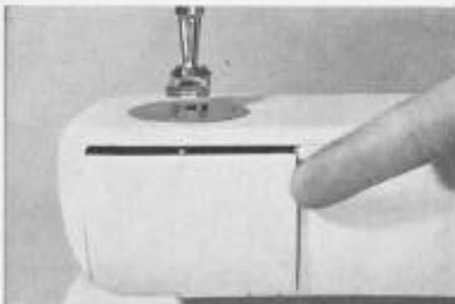
Klappdeckel öffnen. Drehen am Handrad (gegen sich), bis die Nadel oben steht.
