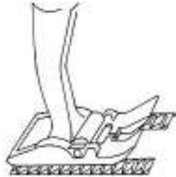
b) Wenn der Nähfuß "schräg" steht, z.B. an einer sehr dicken Naht oder Nähstelle, kann der Transporteur nicht in den Stoff greifen. Die Arbeit staut.
