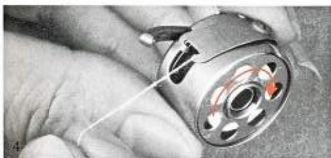
unter die Feder ziehen, bis er in den T-förmigen Schlitz am Ende der Feder zu liegen kommt. Beim Abziehen soll sich die Spule im Uhrzeigersinn drehen, siehe Pfeil.
