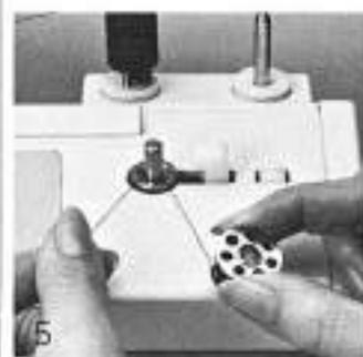
Beim Wegnehmen der Spule Faden abschneiden, indem er über das kleine Messer (Abb. 5) gezogen wird.
