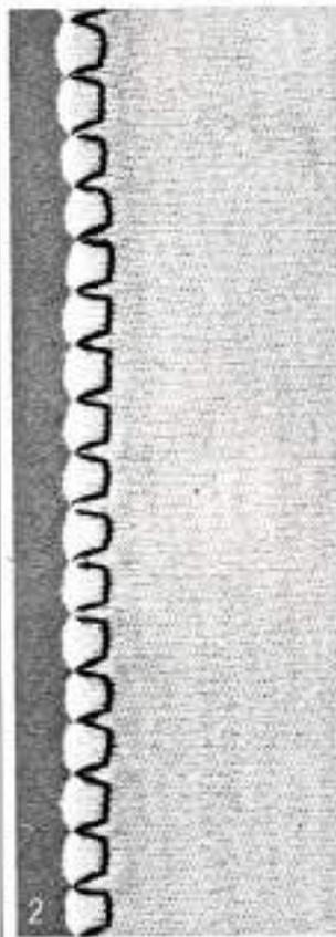
Nähgut so unter den Nähfuss legen, dass die Kante für den Muschelsaum links liegt. Die Nadel soll genau an der Kante ins Leere stechen (Bild 2).
