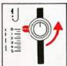
Durch eine halbe Umdrehung nach links - Markierung steht unten - ergibt sich die Grundeinstellung der Stichlänge. = IIIII
