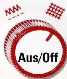
**Der Transporteur** kann mit diesem Knopf abgesenkt werden, z.B. zum Freihand Nähen, Freihand Sticken, Stopfen usw.
