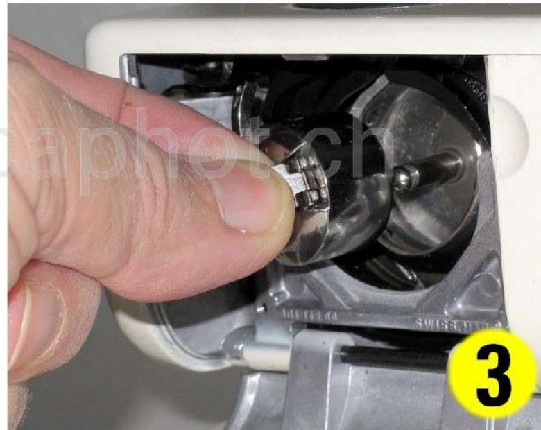
Nach dem Einlegen der Spule in die Kapel (Seite 11) führen wir die Kapel wieder in das Greifersystem ein indem wir diese genauso festhalten wie in Schritt 2 beschrieben (nur eben umgekehrt).
