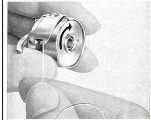
Die Spule wird so in die Kapsel eingelegt dass sich diese beim ziehen am Faden in Pfeilrichtung dreht
