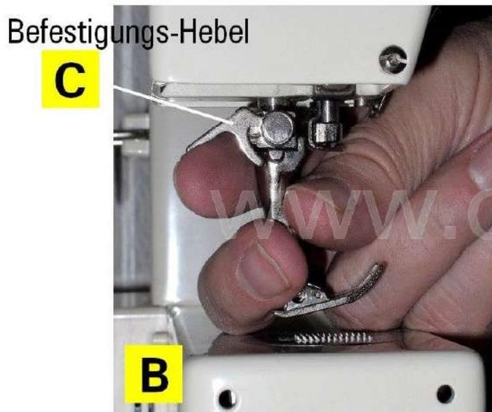
Mit einer Hand fassen wir den Nähfuss (Bild B) ... -Variante 1- lösen den Befestigungshebel (Bild C) und entnehmen den Nähfuss.
