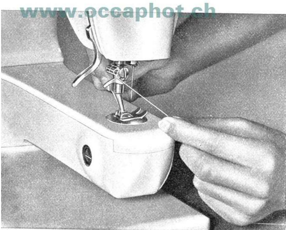
An der BERNINA-Nähmaschine ist der Nähfuß-Spannhebel so ausgebildet, daß er noch als Fadenabschneider benützt werden kann. (Siehe nebenstehende Abb.)
