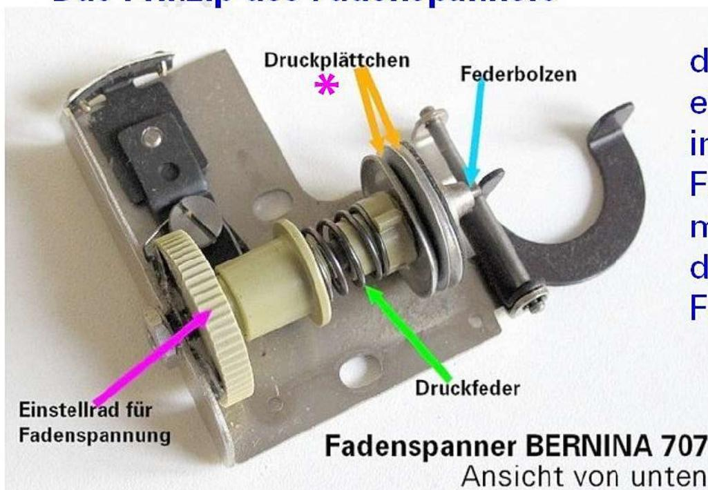
das Bild bietet einen Einblick in den offenen Fadenspanner mit den Plättchen\* durch die der Faden läuft.
