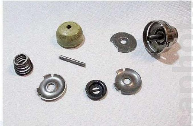
Die erste Scheibe wird so eingelegt, dass der Stift in der hier angezeigten Aussparung liegt.
