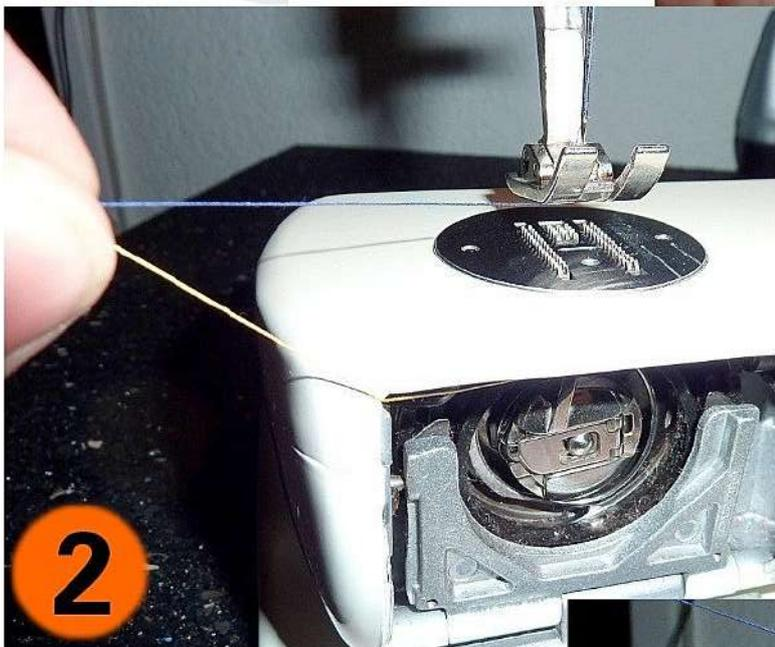
jetzt halten wir beide Fäden und drehen die Nadel am Handrad langsam nach unten
