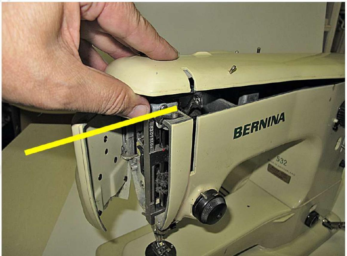
Um Verletzungen an der Maschine zu vermeiden... kleben Sie das Werkzeug mit einem Isolierband ab.
