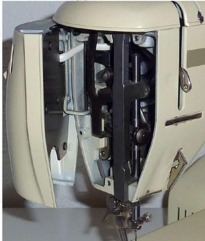
Sitzt der Deckel zu fest oder zu locker... muss nur die Spannklammer je nach Situation nach oben oder unten verbogen werden... und gut ist.
