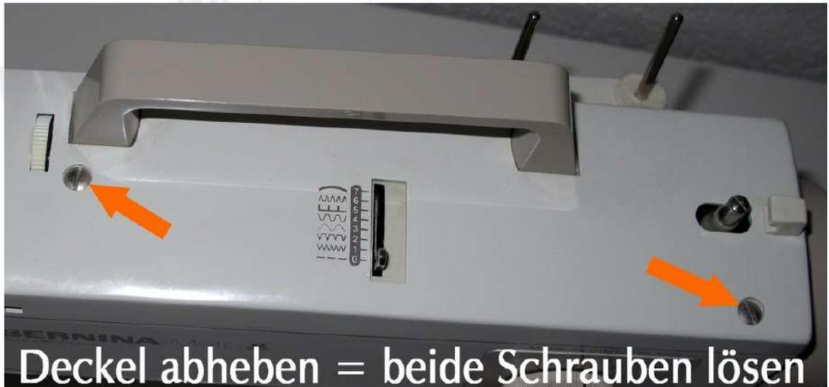
Deckel abheben = beide Schrauben lösen
