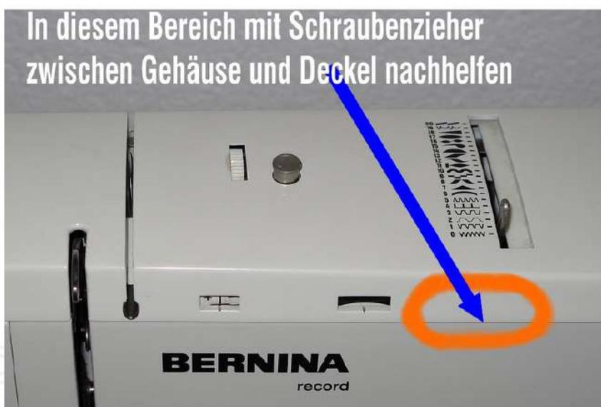
In diesem Bereich mit Schraubenzieher zwischen Gehäuse und Deckel nachhelfen
