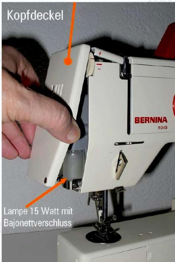
Deckel nach vorne ziehen...leicht nach oben anheben und ausklinken.
