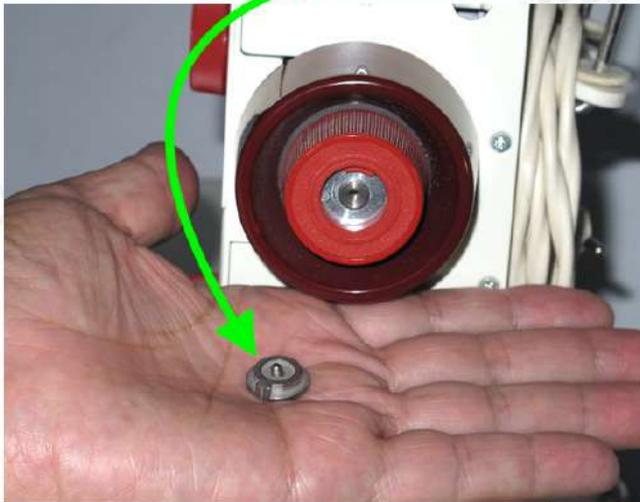
Achtung.. Links-Gewinde zum lösen nach Rechts drehen..!!!
