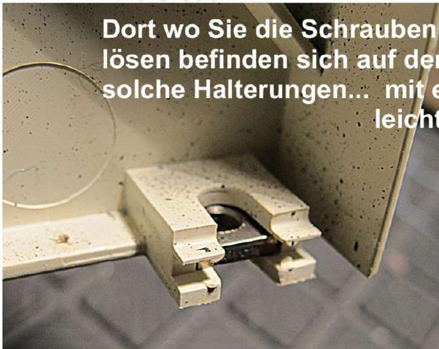
Dort wo Sie die Schrauben der Abdeckung lösen befinden sich auf der Innenseite solche Halterungen... mit einer Mutter die leicht rausfallen kann.
