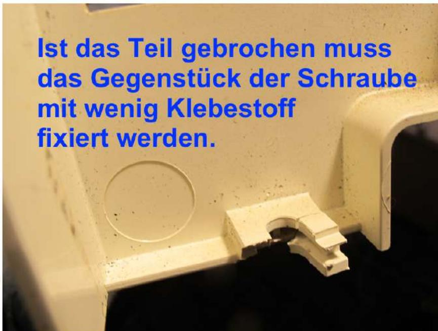
Ist das Teil gebrochen muss das Gegenstück der Schraube mit wenig Klebestoff fixiert werden.
